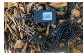
Las sondas de humedad de suelo permitieron obtener información en tiempo real sobre la humedad en la zona radicular, lo que facilitó un uso más óptimo del riego. Por ejemplo, en una de las parcelas, el inicio del **riego según la práctica habitual (Control)** se retrasó casi un mes respecto a la estrategia de **Riego Deficitario Controlado (RDC)**. Esto resultó en un agotamiento de las reservas de agua del suelo durante fases críticas del cultivo.
